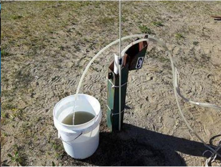
Échantillonnage des piézomètres
