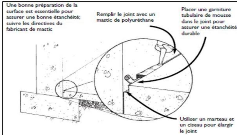
Les ouvertures pratiquées dans un plancher sur sol pour laisser passer des tuyaux ou d'autres objets doivent être rendues étanches au gaz qui se dégage du sol.
