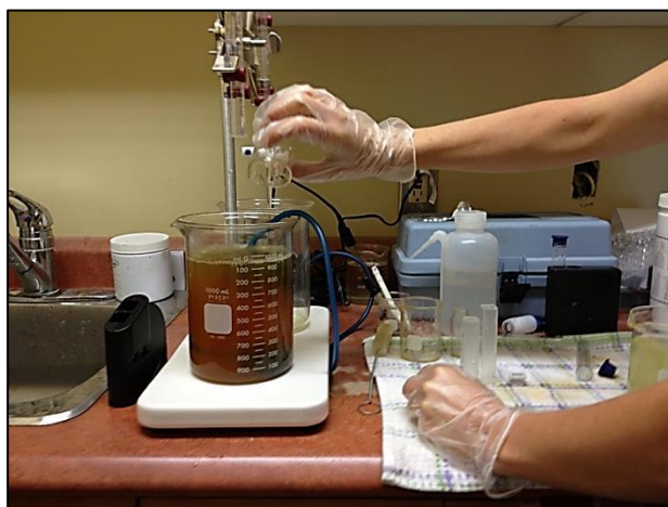
Mélange d'eau brute et le sulfate ferreux
