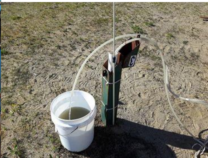
Échantillonnage des piézomètres
