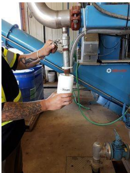
Échantillonnage des boues
